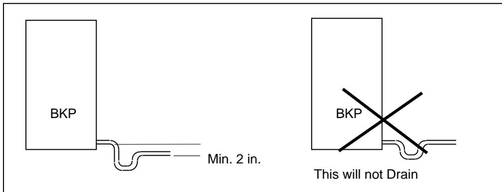
Fig 3.2 Condensate Trap
