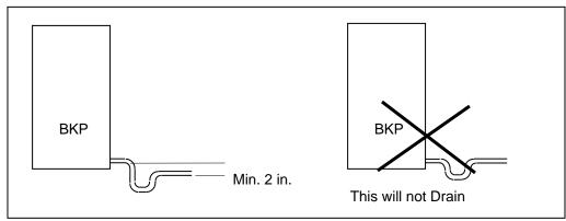
Fig 3.2 Condensate Trap
